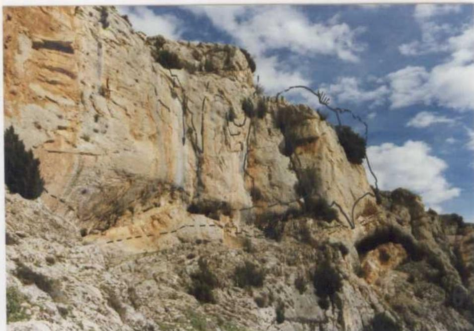
FOTOGRAFIA 6, Vista oblicua del bloque inestable. Obsérvese la fracturación de la roca según planos aproximadamente paralelos al talud a favor de los cuales crece vegetación y circula el agua.
